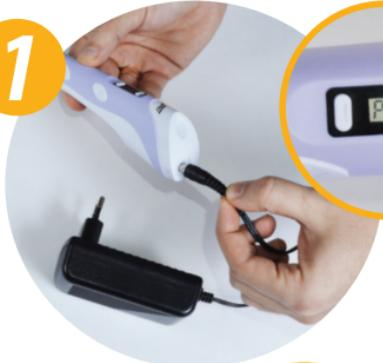
Возьмите адаптер питания и подключите его к устройству, а затем подключите к сети. Загорится желтый индикатор, и надпись на ЖК-дисплее «PLA».
