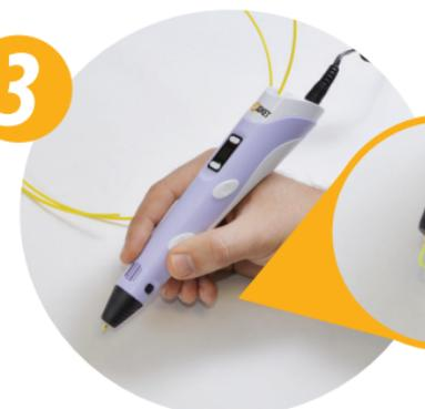
Вставьте заранее подготовленный кусок пластика в отверстие для загрузки пластика (перед загрузкой пластика убедитесь, что его концы ровно обрезаны). Другой рукой нажмите кнопку «Подача пластика» и держите её до тех пор, пока из сопла не появится расплавленный пластик. В ручке также имеется режим автоматической
