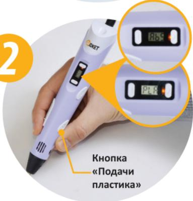
Кнопками регулировки температуры выберите материал, с которым Вы собираетесь работать «PLA» или «ABS». При работе с пластиком Watson также выберите ABS. Далее нажмите кнопку подачи пластика, и ручка автоматически начнет прогрев до необходимой температуры для выбранного вида пластика. Во время прогрева будут гореть красный и желтый индикаторы, на ЖК-дисплее Вы увидите, как идет прогрев устройства\*. Красный индикатор изменится на зеленый, это означает, что устройство готово к использованию.
