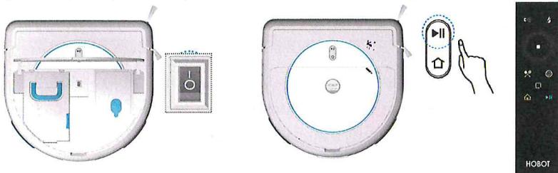
Если уборка началась не от зарядной станции, то установите устройство на пол в нужной комнате, на расстоянии 30-50см от пустого прямого участка стены, разместив передним бампером в сторону стены и нажмите
