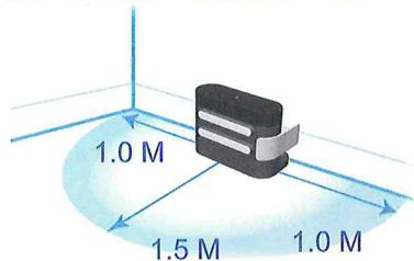
1. Подключите адаптер к станции и в розетку. Установите зарядную станцию около стены на твёрдую поверхность во избежание скольжения при подъезде устройства на базу.
