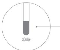
Чистящий ролик является расходным материалом, его рекомендуется заменять один раз в 6 месяцев или по мере загрязнения. Когда индикатор замены ролика основного корпуса становится оранжевым – необходимо заменить ролик. После замены ролика коротко нажмите кнопку питания, затем нажмите и удерживайте кнопку самоочистки в течение 5 секунд, ролик автоматически очищается, а индикатор замены ролика выключается.
