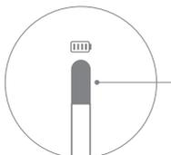
В состоянии включения питания индикатор горит белым цветом. В выключенном состоянии индикатор выключен.
