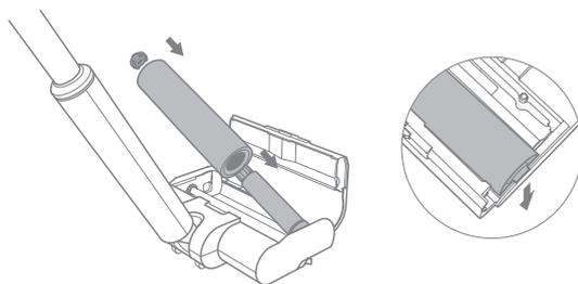
△ Примечание: обратите внимание на направление при размещении ролика. Когда ролик установлен правильно, кнопка замены ролика автоматически отскакивает и сбрасывается. Ролик является расходным материалом, рекомендуется снимать ролик для очистки каждый месяц и заменять на новый каждые 6–12 месяцев. Кнопка замены ролика не является расходным материалом, не выбрасывайте ее при замене ролика.
