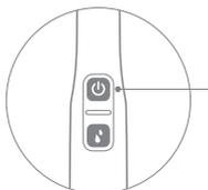
Нажмите на кнопку включения, для активации устройства. Повторное нажатие выключит устройство.
