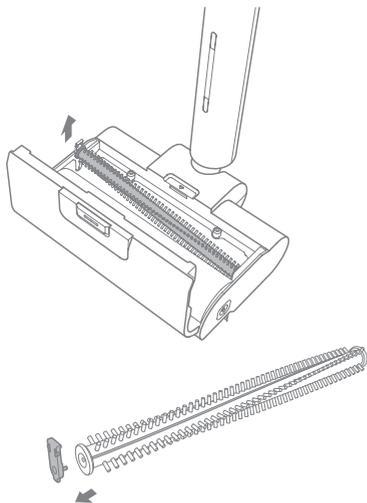
△ Примечание: когда вы открываете крышку основного корпуса для замены или очистки роликовой щетки, будьте аккуратны с металлической частью, чтобы избежать травмы.
