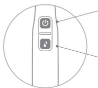
Когда электрошвабра установлена на станции, коротко нажмите кнопку включения, чтобы высушить ролик.
