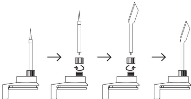
Для правильной замены нагревательной струны в насадке для резки действуйте в соответствии с рисунком:
