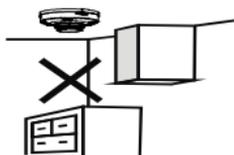
**Рядом с приточным вентилятором или кондиционером.** Не ближе, чем на расстоянии 1,5 м. При наличии потока воздуха дым может быть не обнаружен.
