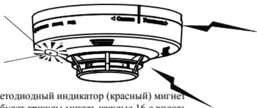
После того как светодиодный индикатор (красный) мигнет 3 раза подряд, он будет трижды мигать каждые 16 с вплоть до устранения неисправности или нажатия кнопки.
